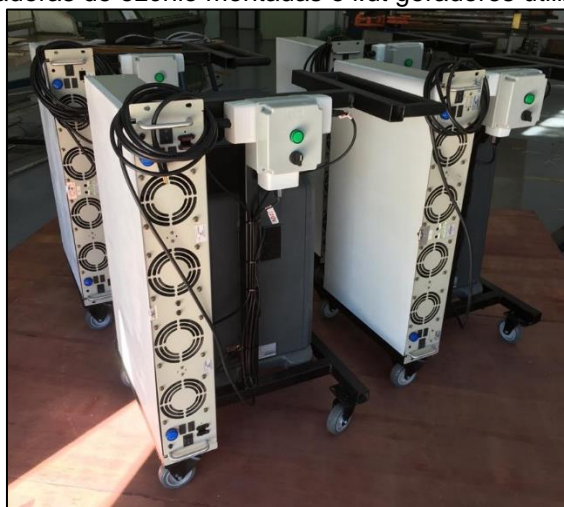
Figura 14 – Unidades geradoras de ozônio montadas o i.dt geradores utilizados nas salas de aulas
