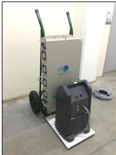
Figura 15 – Unidades geradoras de ozônio montadas o i.dt unidade móvel utilizada em ambientes de difícil acesso.
