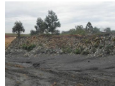
Vista parcial da área em superfície do antigo lixão com deposição irregular de resíduos sólidos urbanos misturados a rejeitos piritosos de beneficiamento de pirita.
