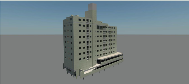
Figura 9 – Projeto Arquitetônico e Estrutural associados no Navisworks
