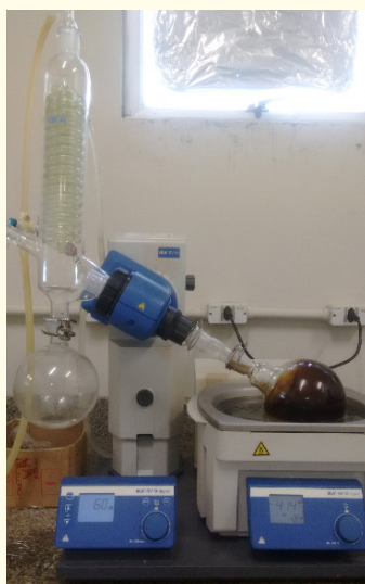
Figura 8 – Rotaevaporador - destilação acelerada para recuperação do ligante
