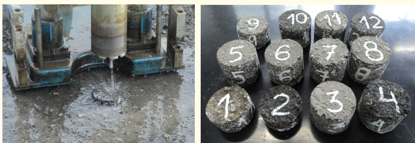
Figura 3 – Corpos de prova coletados em campo: (a) extração com sonda rotativa e (b) amostras em laboratório
