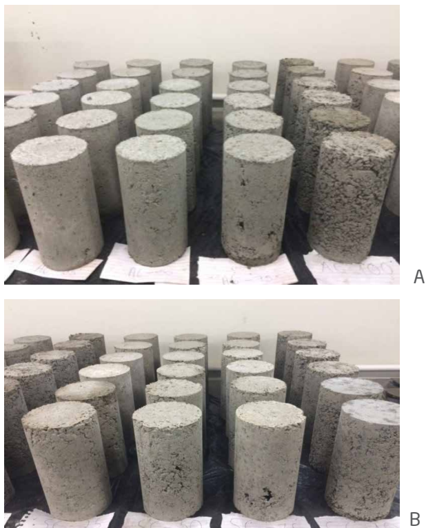
Figura 4 - Concretos obtidos com resíduo têxtil. A) adição de resíduo; B) substituição do cimento pelo resíduo, Criciúma (SC)
