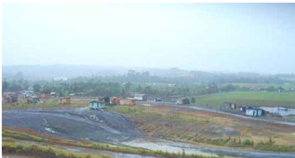
Figura 1 - Vista desde o alto, da área ocupada por resíduos sulfurosos (pirita) resultantes da exploração do carvão. Podem observar-se moradias construídas sobre resíduos minerais tóxicos (de cor preta). As partes escavadas formam lagoas ácidas resultantes do contato da água de chuva com o enxofre contido na pirita.
