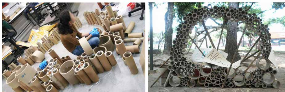
Figura 4 - Esq.: Tubos de papelão sendo colados uns aos outros sobre o desenho no chão do ateliê. Dir.: Mobiliário locado no pátio do CAU-Unesc, apoiado sobre escoras para que seque a cola
