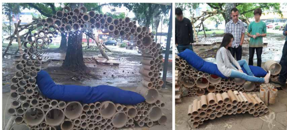
Figura 5 - Esq.: Mobiliário pronto e sem o escoramento. Dir.: Mobiliário durante a apresentação, depois de não ter resistido ao seu peso
